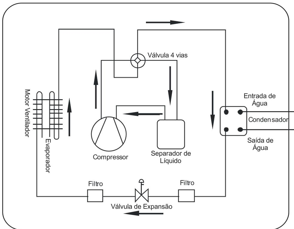
Durante o processo de operação, a bomba de calor RV absorverá grande parte da energia térmica do ar e a transferirá para a água, juntamente com a energia proveniente do trabalho do compressor.
